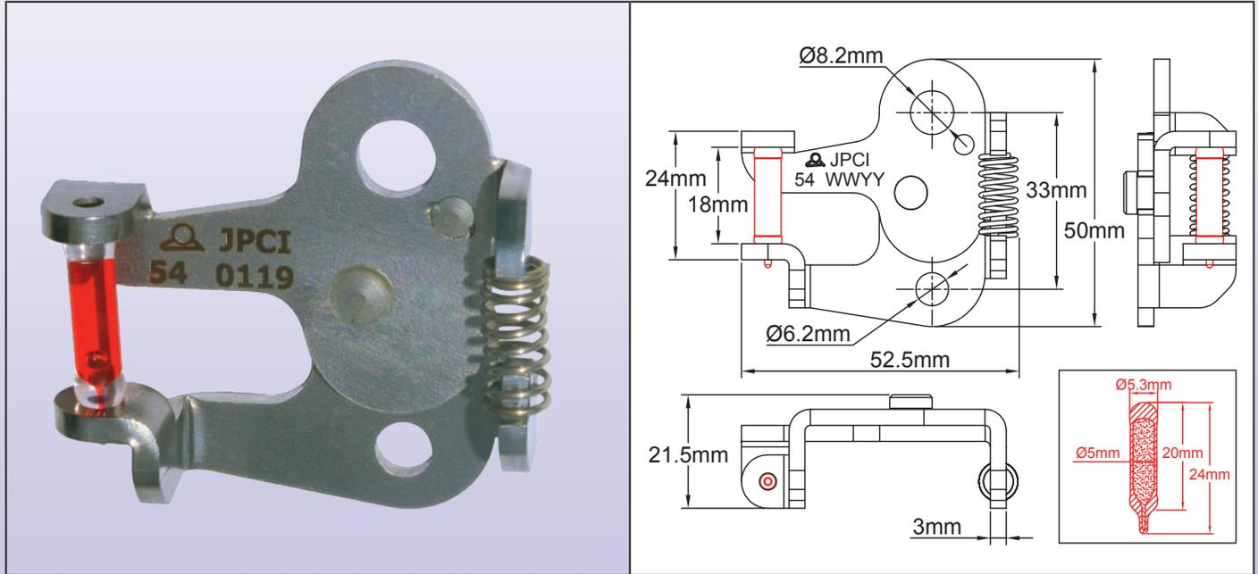
用 3mm 厚的镀锌钢制成，这些压缩机械装置与 20x5mm 的感温玻璃珠相兼容。其巨大的倍增系数将施加在感温玻璃珠的力度减少到仅应用于机械装置的力量度的 15%。更换感温玻璃珠很简单，无需特殊的工具便可完成。它们在 5 分钟内承受 300DaN 的过载，最小负载为 0.4DaN。
