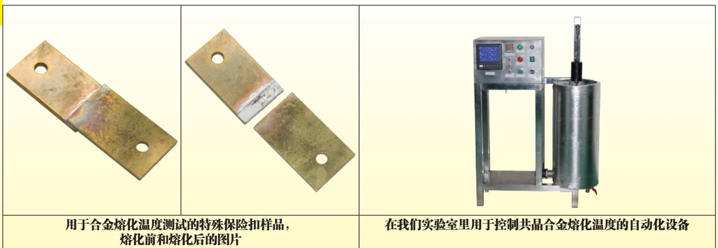
用于合金熔化温度测试的特殊保险扣样品，熔化前和熔化后的图片
