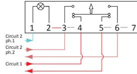
在触发器触点上（电路 1）许多串联连接设备的打开及在触发器触点上（电路 2）并联连接的闭合。在电路 2 的指示灯显示电源打开。
