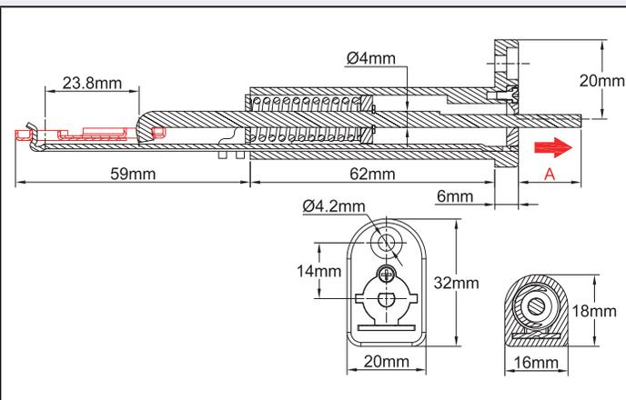
这些机械的热驱动装置用于关闭在通风管道上使用的防火阀。其大的操作力解开弹簧以驱动阻尼器。不需要电源，这些设备特别简单可靠。所有的防火阀均被强制性要求必须符合 NF-S 61.937 标准。它们产生的力与共晶保险扣相兼容，焊接表面等于或大于 200mm<sup>2</sup>\*。但是，某些当地法规可能会要求定期更换保险扣或热驱动器。
